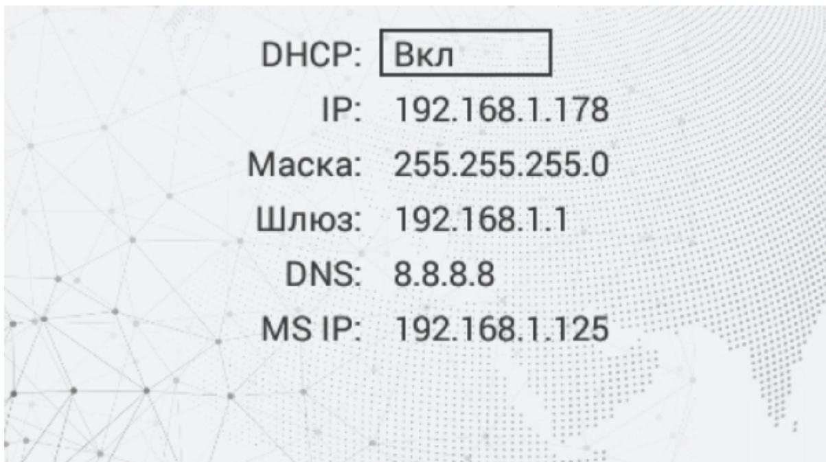
**DHCP:** Включение/выключение режима получения сетевых настроек автоматически.
