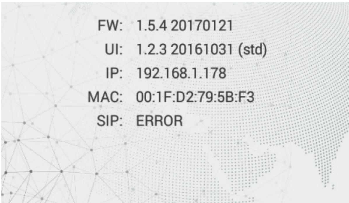
В данном окне отображается текущее состояние SIP подключения, текущий IP адрес, MAC-адрес и текущая версия прошивки.
